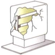
著しく破損し、又は老朽したものの
