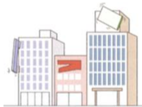
倒壊又は落下のおそれがあるもの
