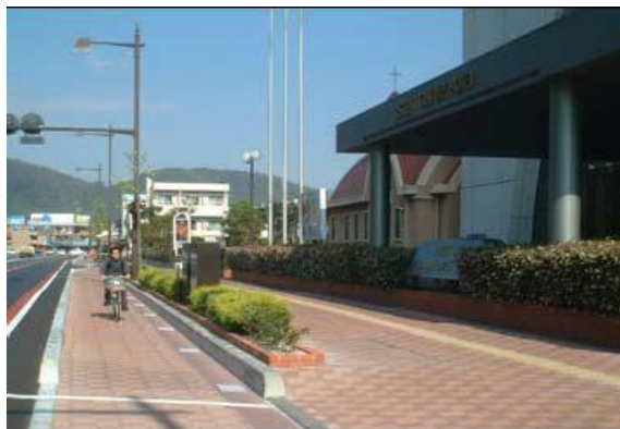
車道の幅員構成を見直し、自転車走行空間を確保した事例
